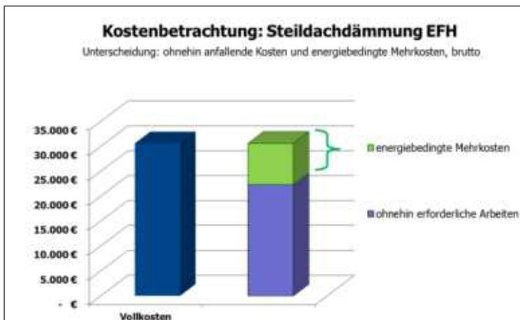
Abbildung 8-11: Unterscheidung Vollkosten und energiebedingte Mehrkosten, Bsp. Dachsanierung
