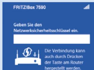
Drücken Sie die Taste „Connect/WPS“ bis die LEDs „WLAN“, „DECT“ und „Connect“ blinken.
